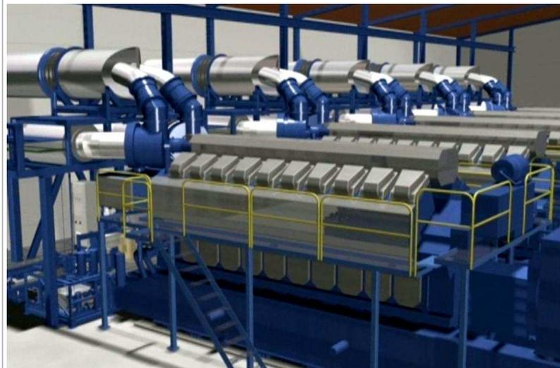
Os geradores e os motores serão instalados em uma mesma base estrutural utilizando fundação de concreto. Na Figura a seguir está ilustrado o desenho de uma planta típica de uma casa de geradores e motores Wärtsilä.
