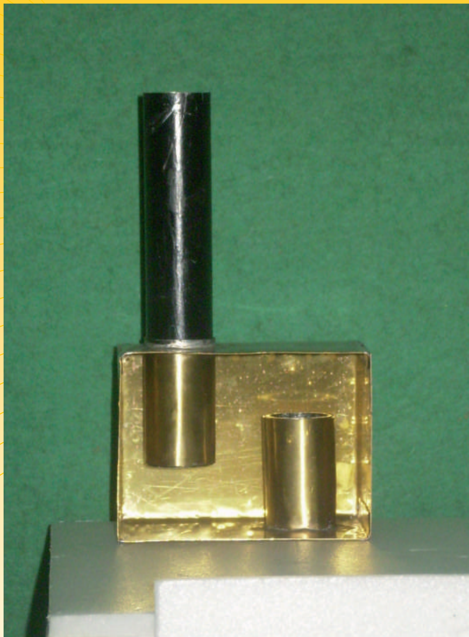
Foto 03 – Visão interna da Caixa de Fumaça, mostrando o desencontro da chaminé de saída do forno e da chaminé externa.
