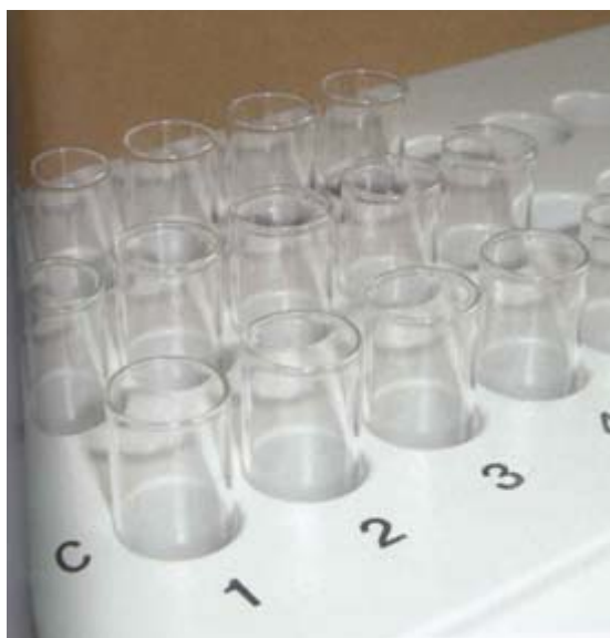
Figura 36 – Cubetas posicionadas no termobloco para a execução da leitura final do teste. Fonte: Testes Ecotoxicológicos, Métodos, Técnicas e Aplicações.
