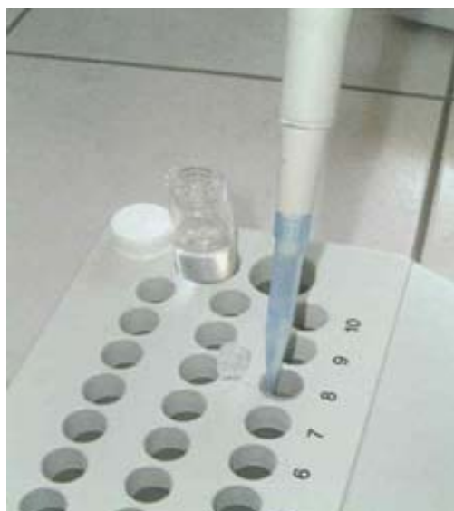
Figura 32 – Colocação da solução de reconstituição na suspensão de bactérias. Fonte: Testes Ecotoxicológicos, Métodos, Técnicas e Aplicações.
