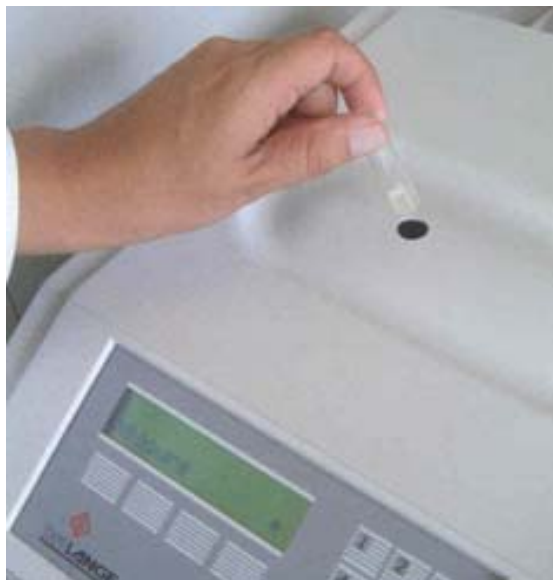
Figura 37 – Colocação da cubeta-teste no luminômetro para realização da leitura final do teste. Fonte: Laboratório de Ecotoxicologia da CPRH. Foto: Dr. Knie (2002.).
