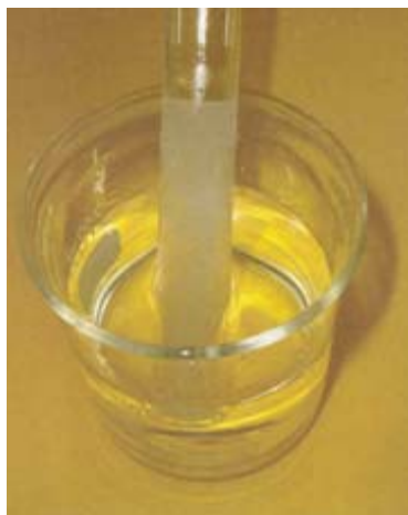
Figura 28 – Descongelamento da solução de reconstituição em banho-maria. Fonte: Testes Ecotoxicológicos, Métodos, Técnicas e Aplicações.
