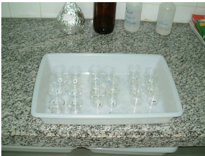
Figura 42 – Preparação para realização dos Testes de Toxicidade aguda com Daphnia magna - Fonte: Laboratório de Ecotoxicologia da CPRH - Foto Dr. Kinie (2003).
