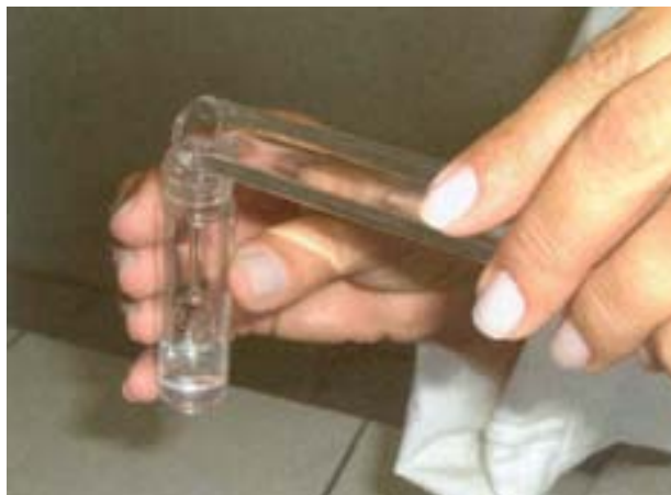
Figura 29 – Transferência da solução de reconstituição para o frasco a ser incubado no termobloco. Fonte: Testes Ecotoxicológicos, Métodos, Técnicas e Aplicações.
