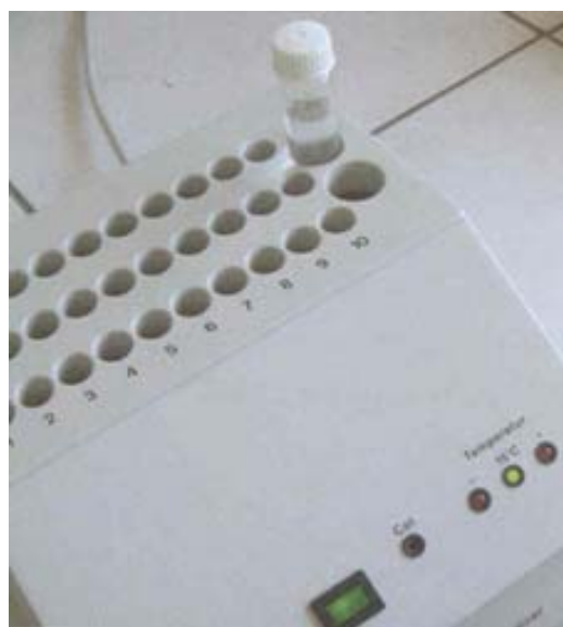
Figura 30 – Incubação da solução de reconstituição no termobloco. Fonte: Testes Ecotoxicológicos, Métodos, Técnicas e Aplicações.
