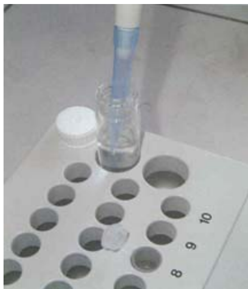
Figura 31 – Retirada da solução de reconstituição. Fonte: Testes Ecotoxicológicos, Métodos, Técnicas e Aplicações.
