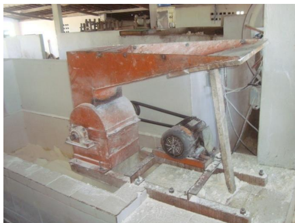
Figura 15 B - Peneira elétrica em casa de farinha n°.13 - Olho D' Água Velho - Lajedo
