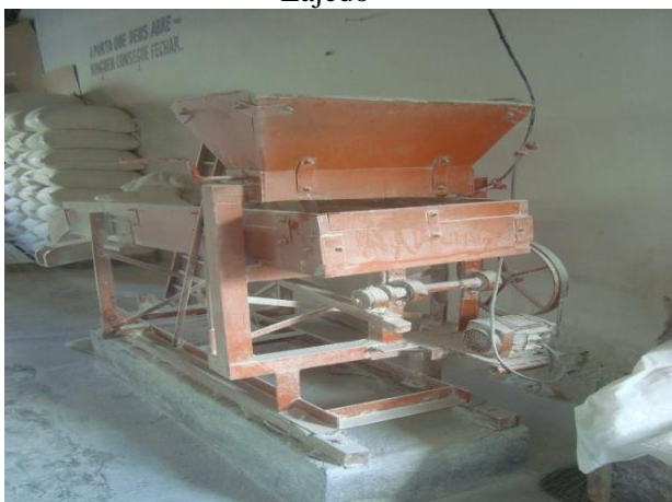
Figura 15 A - Peneira elétrica em operação em casa de farinha n°. 13 - Olho D' Água Velho - Lajedo
