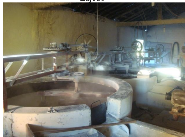
Figura 16 B - Forno em operação em casa de farinha n.º 11 - Olho D' Água dos Pombos - Lajedo
