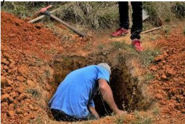
Foto 2 - coleta de amostra de solo do primeiro perfil.
