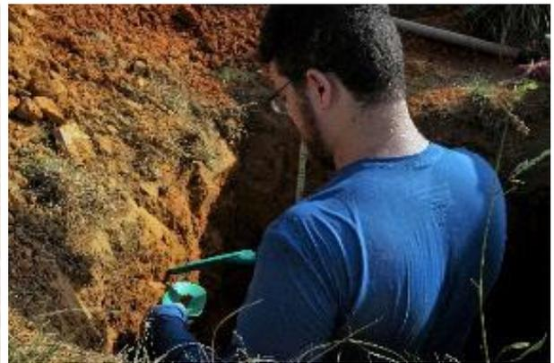
O Perfil 5 (LD10) foi um perfil composto. Além da escavação com profundidade de 1,5m, também se coletou amostra acima deste perfil de um paredão adjacente a ele. Para a coleta no paredão, realizou-se a limpeza da camada superficial com auxílio de uma espátula de plástico para se evitar contaminação.
